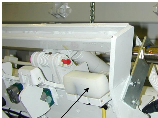
zubová anténa FDX (velikost ~5 cm, paralelní) transponder skleněná trubička
